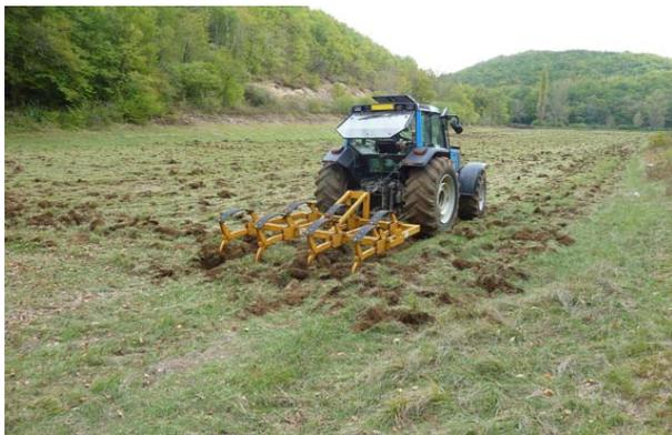
**Photo 3** : Le sous-solage en plein à la sous-soleuse agricole à 7 dents a été réalisé jusqu'à 50 cm de profondeur
